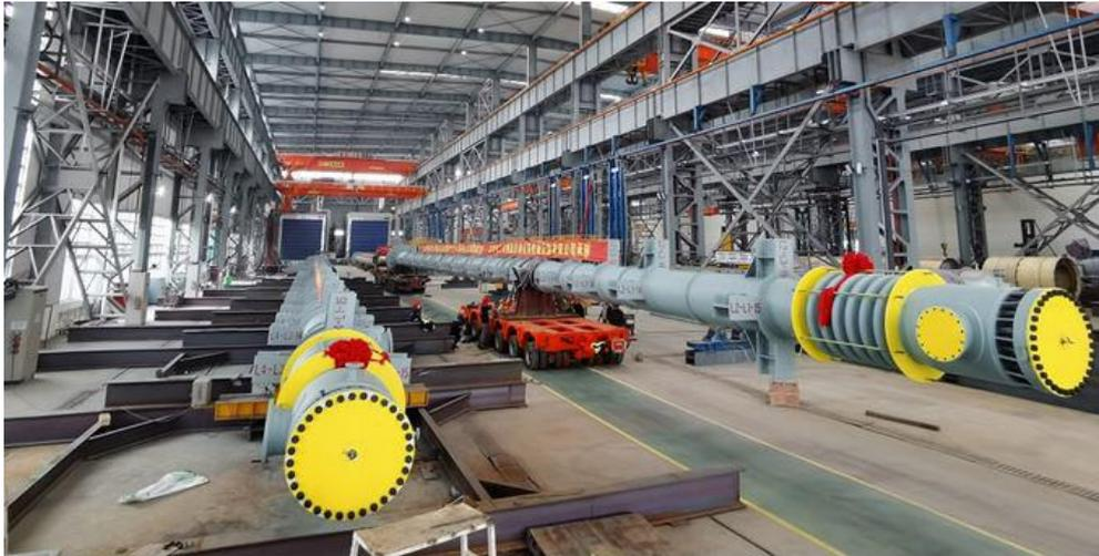
环管反应器是 BASSELL 工艺聚丙烯装置中的关键核心设备，更是装置的“命门”，其性能直接影响装置正常运行和产品品质。此前，国内外还没有同等规模的装置。为突破聚丙烯领域的“卡脖子”技术，中国软包装集团通过多方调研、考察，了解到天华院多年前就开展了环管反应器的研究、设计工作，在强度计算、应力分析、模态分析、流场模拟、制造等方面具有较强的技术实力和技术储备，由此决定由天华院担此重任为中国软包装集团进行国产化，对聚丙烯领域“卡脖子”技术攻坚克难。
