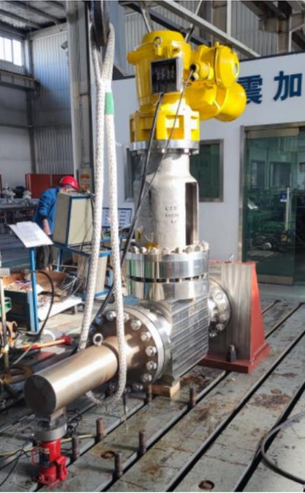
3月30日,在中核科技高温高压试验室, DN250 氦气隔离阀的端部加载试验、动态特性探测试验以及地震静载荷试验顺利完成,标志着高温气冷堆DN250氦气隔离阀样机的水回路鉴定试验取得圆满成功。
