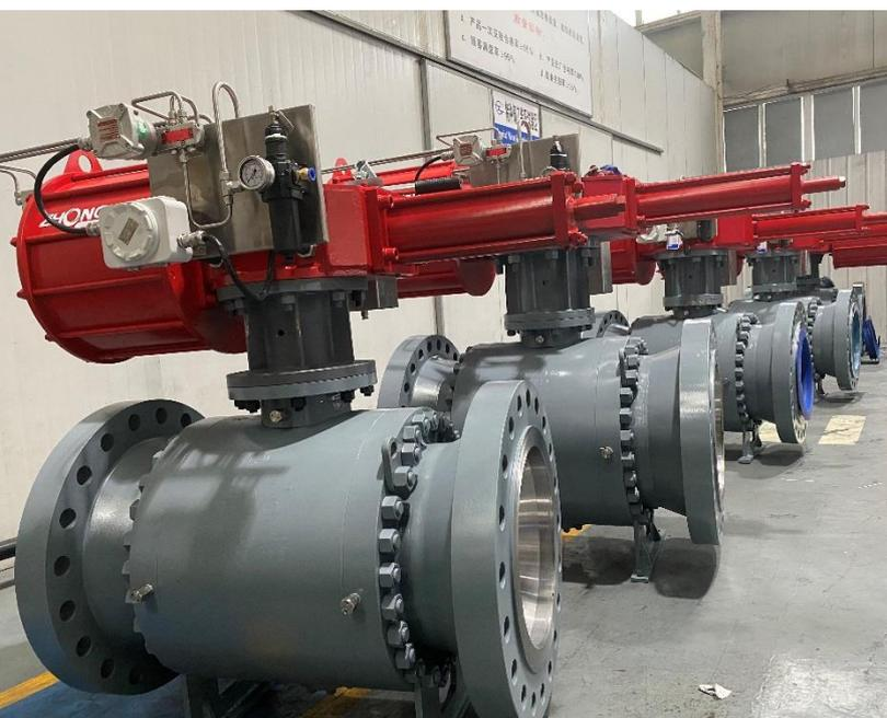
上海凯工阀门股份有限公司近日生产完成的出口到中亚乌廉戈天然气气田项目一批气动装置大口径球阀(DN1200-PN40、DN1000-PN40、DN800-PN40、DN500-PN40)等，一次性通过阀门各项功能测试和试验全部性能指标检测合格，并通过客户和第三方的现场验收合格。
